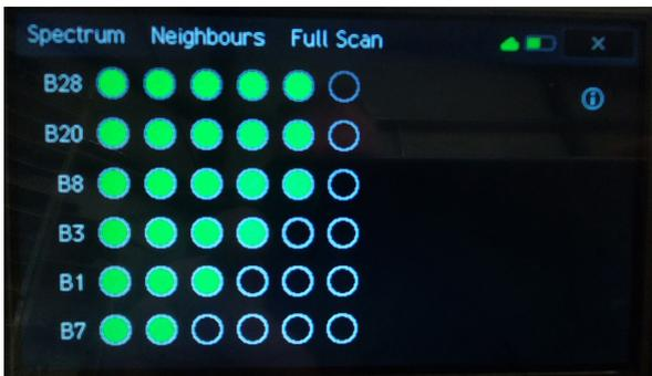
Ce mode permet à l'installateur de comprendre plus clairement comment les ondes radio (RF) se propagent dans tout le bâtiment. Cela peut aider l'installateur à mieux comprendre à quelle distance il peut s'attendre à ce que le signal intérieur se propage. Il peut également être utilisé pour comprendre la composition des matériaux des murs et des portes.
